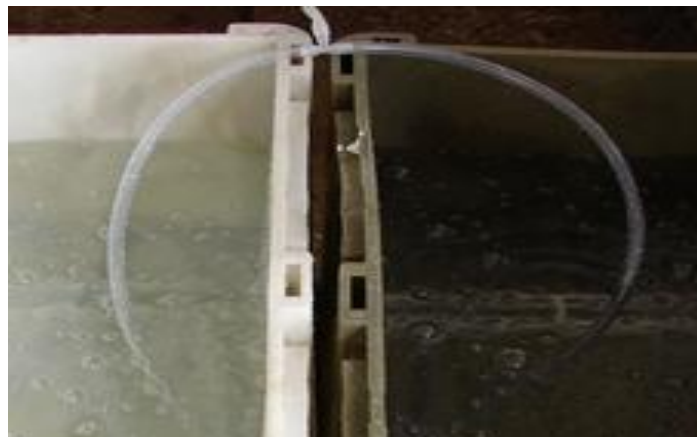
Figura 3. Escalado de dos reactores en paralelo con el empleo de una conexión en T.
