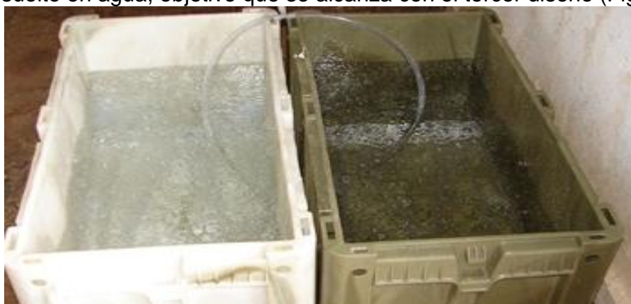
Figura 4. Burbujeo homogéneo en el tercer diseño de difusión de ozono en agua.
